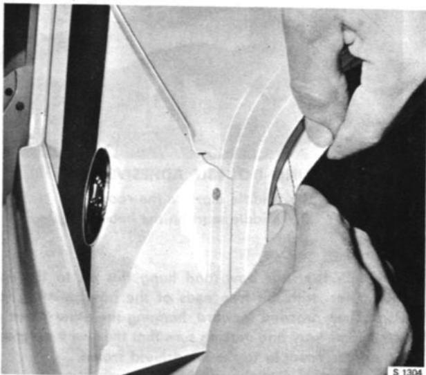
LOCATION OF SIDE SEAM OVER THE WELDING SEAM BETWEEN ROOF AND SIDE VALANCE
