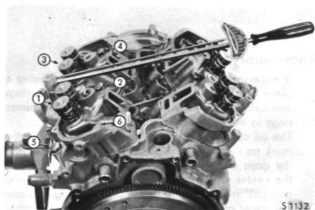
**TORQUING THE CYLINDER HEAD**
